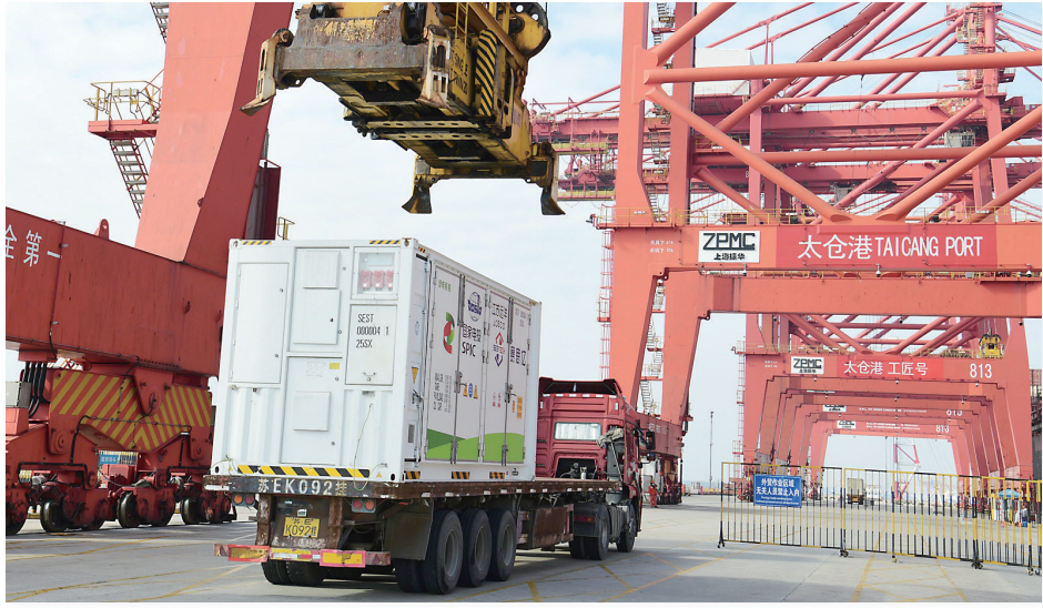
集装箱车装载着完成充电的电池前往码头进行换电作业
