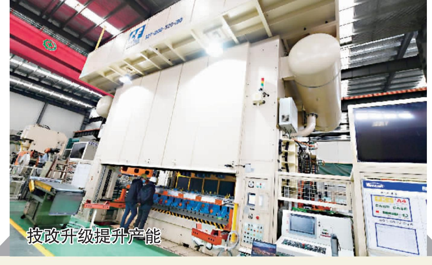
双凤镇一家汽配生产企业技术人员正对一台千吨级冲压机床进行设备调试。近两年来,双凤镇一批汽配制造企业通过引进先进流水线,加大技改投入,提升产品的市场竞争力,不少汽配制造企业的智能化生产率占比超过50%。
