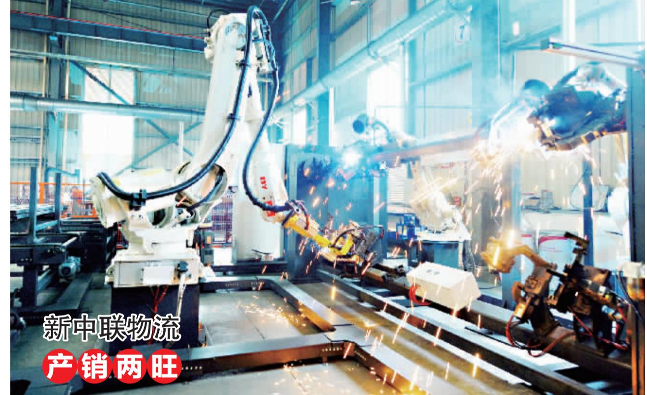
新中联物流设施(苏州)有限公司的机械手正在自动焊接货架。随着岁末临近,该公司生产的物流货架设备产销两旺。目前每月生产出口海外市场的货架产品超过千吨。
